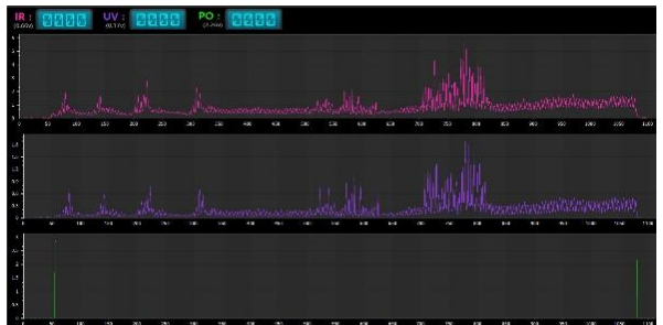
< 용접 불량 발생시 측정 결과 >
